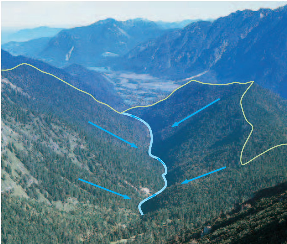
In kreisrunden Einzugsgebieten läuft das Wasser aus allen Teilen des Gebietes gleichzeitig zusammen und bildet steile, kurze Abflußwellen. In lang gestreckten Einzugsgebieten verteilt sich das Wasser gleichmäßiger über die Länge des Flusses. Es entstehen flache und lange Abflußwellen.
